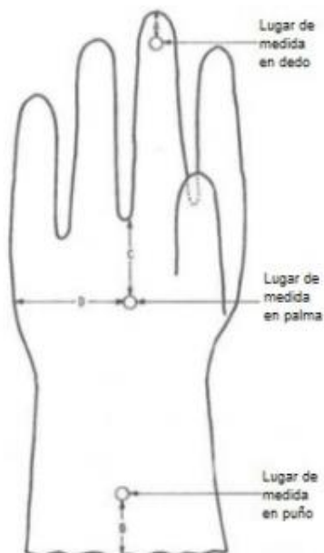
FIGURA N° 2: Puntos de medición para espesor
