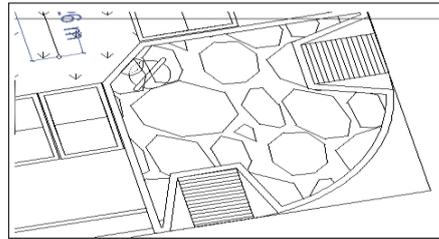
En la parte interior del parque se plantea construir una glorieta central, en forma circular, la cubierta será de Planchas de TR-4 de 10 ondas de fibra vegetal y cubrirá la glorieta.
