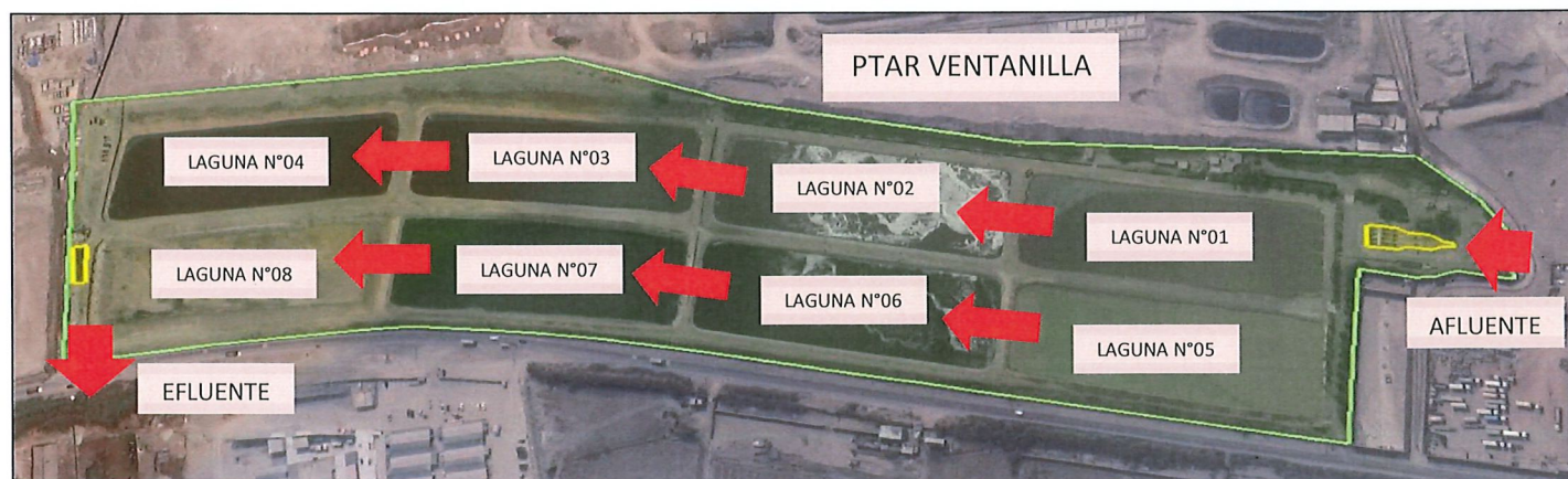
Figura n°02: Configuración hidráulica de la PTAR Ventanilla
