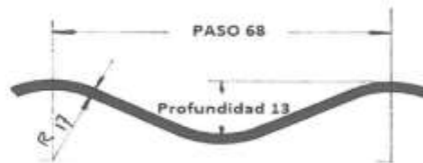
Figura 1. Dimensiones de la corruuga 68 mm x 13 mm
