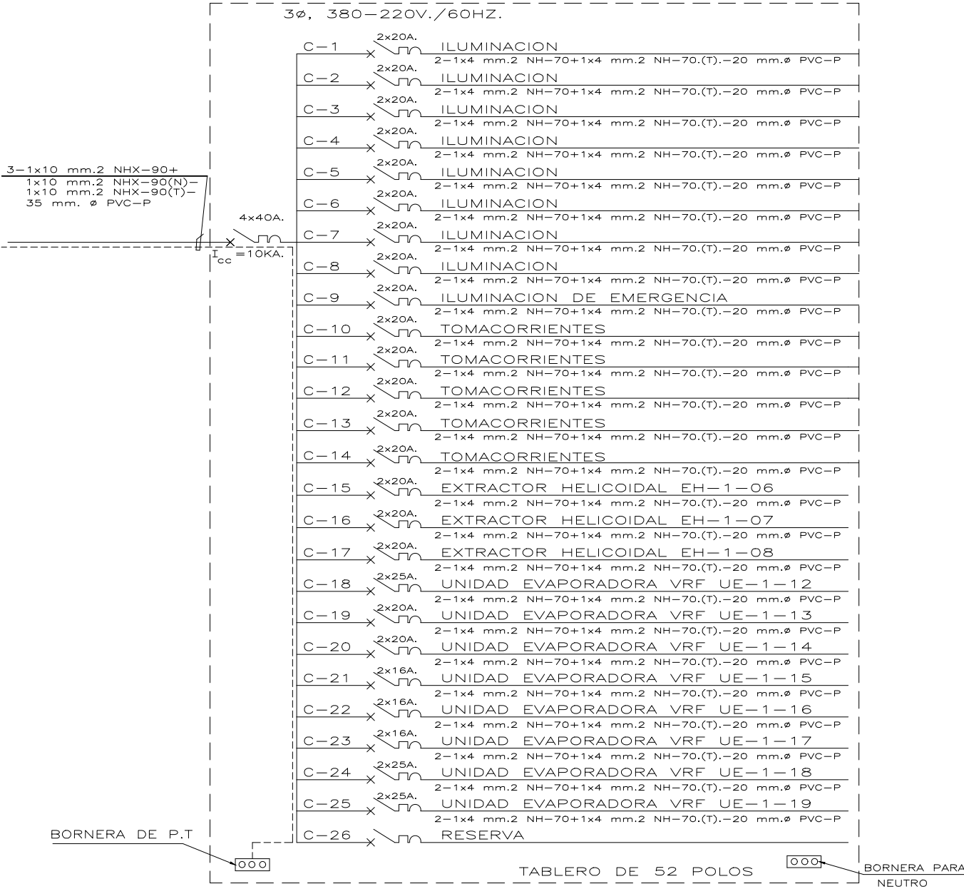
ESQUEMA DEL TABLERO TD-1.2 (EXISTENTE)
