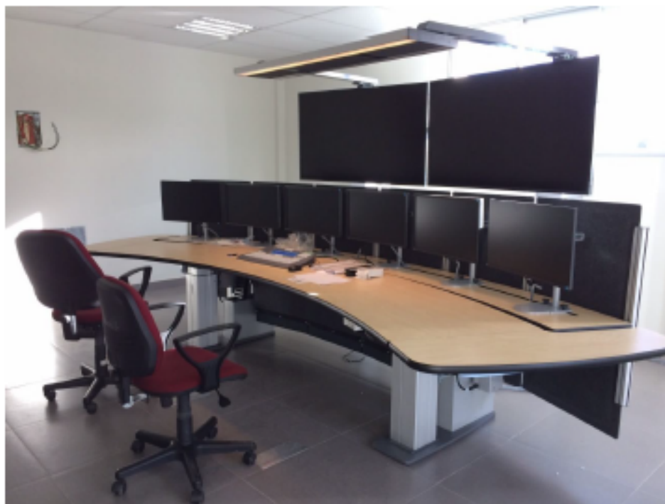
Ilustración 2: Consola de Control (Extended Operator Workplace - EOW) de EGASA para uso del Ingeniero de Turno y del Operador
