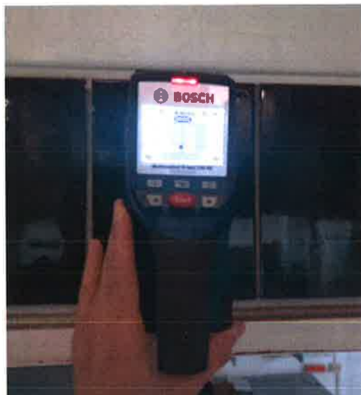
Fig 02, Lectura de estribos en vigas de pórticos principales
