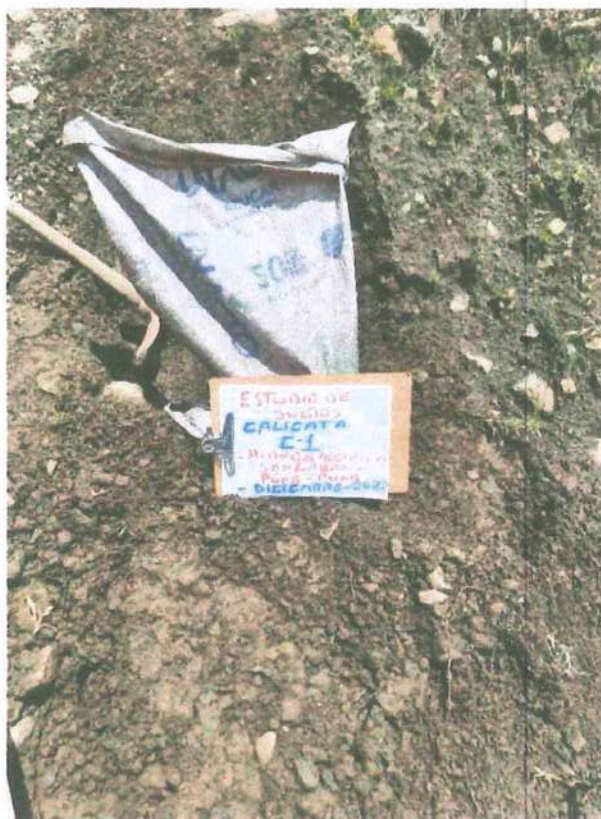
Gráfico N°16: Muestreo para ensayos en Laboratorio de Suelos.
