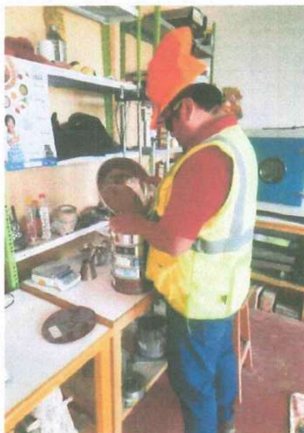
GRAFICO N°5: ENSAYO ANALISIS GRANULOMETRICO DEL AGREGADO FINO
