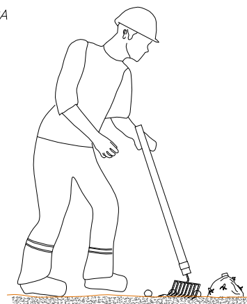
PASO 3 LIMPIEZA DE LA SUPERFICIE DEL TERRENO.
