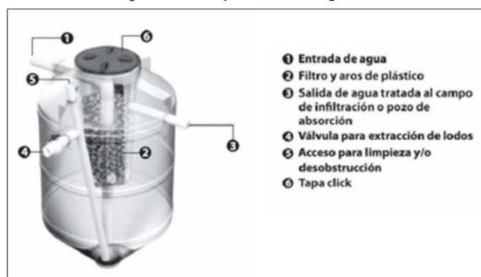
Figura N° 2. Componentes del biodigestor
