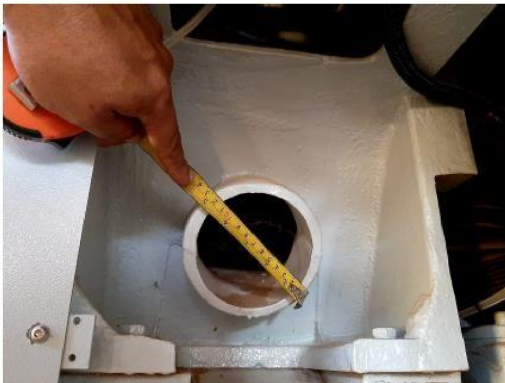
VISTA POSTERIOR (CONECTAR CON MANGUERAS LOS DUCTOS HACIA LAS BOCAS DE SALIDA)
