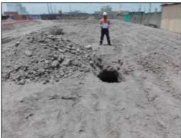
FOTO 15 Y 16 EN LAS VISTAS MOSTRADAS SE OBSERVA LA UBICACION DE LA CALICATA P-4, CONFORMADO POR SUELO LIMOSO LIGERAMENTE ARCILLOSO CON GRAVAS AISLADAS, SEMICOMPACTO, SUBYACIENDO SUELO GRAVOSO POBREMENTE GRADUADA, CON BOLONERIA DE TAMAÑO MAXIMO DE 10", EN ESTADO SEMICOMPACTO.
