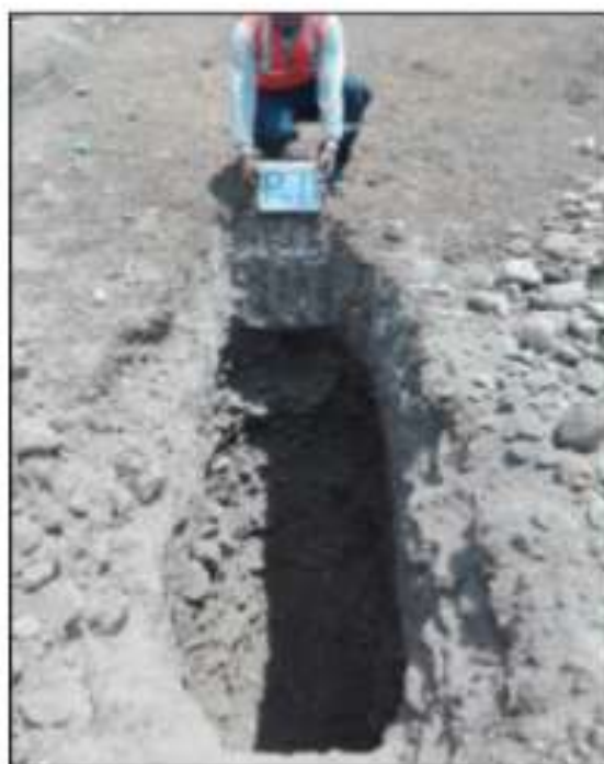
FOTO 1 Y 2 EN LAS VISTAS MOSTRADAS SE OBSERVA LA UBICACION DE LA CALICATA P-1, CONFORMADO POR SUELO LIMOSO LIGERAMENTE ARCILLOSO CON GRAVAS AISLADAS, SEMICOMPACTO, SUBYACIENDO SUELO GRAVOSO POBREMENTE GRADUADA, CON BOLONERIA DE TAMAÑO MÁXIMO DE 22", EN ESTADO SEMICOMPACTO.
