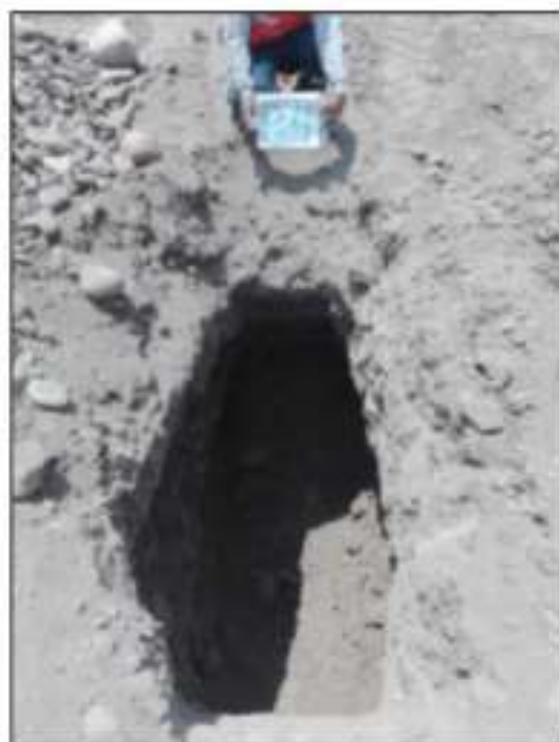
FOTO 13 Y 14 EN LAS VISTAS MOSTRADAS SE OBSERVA LA UBICACION DE LA CALICATA P-1, CONFORMADO POR SUELO LIMOSO LIGERAMENTE ARCILLOSO CON GRAVAS AISLADAS, SEMICOMPACTO, SUBYACIENDO SUELO GRAVOSO POBREMENTE GRADUADA, CON BOLONERIA DE TAMAÑO MÁXIMO DE 16", EN ESTADO SEMICOMPACTO.
