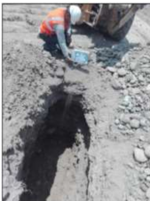
FOTO 9 Y 10 EN LAS VISTAS MOSTRADAS SE OBSERVA LA UBICACION DE LA CALICATA P-3, CONFORMADO POR SUELO LIMOSO LIGERAMENTE ARCILLOSO CON GRAVAS AISLADAS, SEMICOMPACTO, SUBYACIENDO SUELO GRAVOSO POBREMENTE GRADUADA, CON BOLONERIAS EN ESTADO SEMICOMPACTO.
