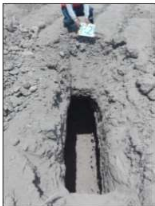
FOTO 7 Y 8 EN LAS VISTAS MOSTRADAS SE OBSERVA LA UBICACION DE LA CALICATA P-2, CONFORMADO POR SUELO LIMOSO LIGERAMENTE ARCILLOSO CON GRAVAS AISLADAS, SEMICOMPACTO, SUBYACIENDO SUELO GRAVOSO POBREMENTE GRADUADA, CON BOLONERIAS EN ESTADO SEMICOMPACTO.
