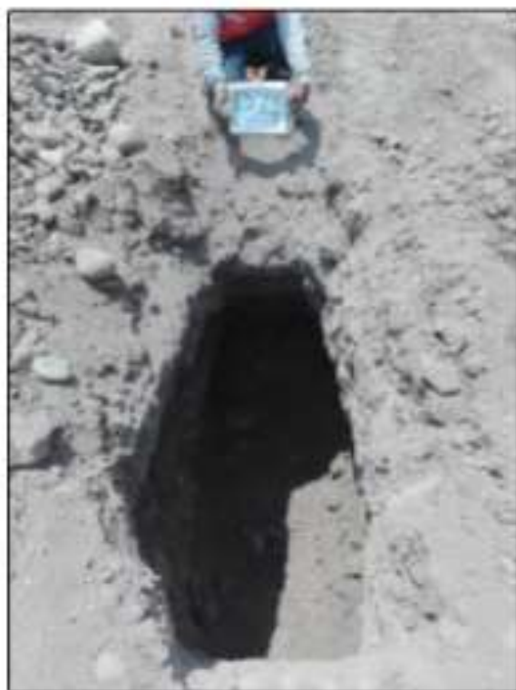
FOTO 15 Y 16 EN LAS VISTAS MOSTRADAS SE OBSERVA LA UBICACION DE LA CALICATA P-4, CONFORMADO POR SUELO LIMOSO LIGERAMENTE ARCILLOSO CON GRAVAS AISLADAS, SEMICOMPACTO, SUBYACIENDO SUELO GRAVOSO POBREMENTE GRADUADA, CON BOLONERIA DE TAMAÑO MAXIMO DE 10", EN ESTADO SEMICOMPACTO.
