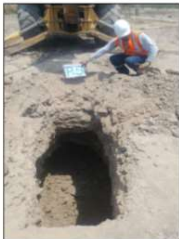
FOTO 17 Y 18 EN LAS VISTAS MOSTRADAS SE OBSERVA LA UBICACION DE LA CALICATA P-5, CONFORMADO POR SUELO LIMOSO LIGERAMENTE ARCILLOSO CON GRAVAS AISLADAS. SEMICOMPACTO, SUBYACIENDO SUELO GRAVOSO POBREMENTE GRADUADA, CON BOLONERIA DE TAMAÑO MAXIMO DE 18", EN ESTADO SEMICOMPACTO.
