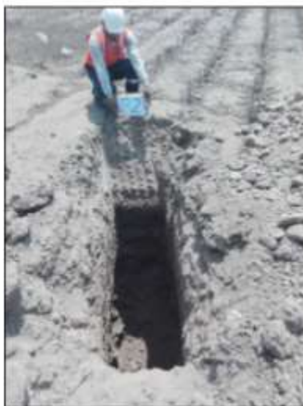
FOTO 5 Y 6 EN LAS VISTAS MOSTRADAS SE OBSERVA LA UBICACION DE LA CALICATA P-2, CONFORMADO POR SUELO LIMOSO LIGERAMENTE ARCILLOSO CON GRAVAS AISLADAS, SEMICOMPACTO, SUBYACIENDO SUELO GRAVOSO POBREMENTE GRADUADA, CON BOLONERIAS EN ESTADO SEMICOMPACTO.
