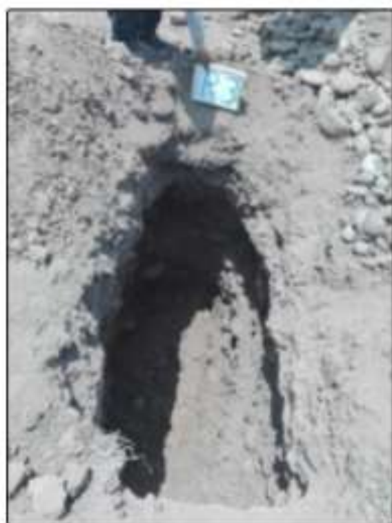
FOTO 11 Y 12 EN LAS VISTAS MOSTRADAS SE OBSERVA LA UBICACION DE LA CALICATA P-3. CONFORMADO POR SUELO LIMOSO LIGERAMENTE ARCILLOSO CON GRAVAS AISLADAS, SEMICOMPACTO, SUBYACIENDO SUELO GRAVOSO POBREMENTE GRADUADA, CON BOLONERIAS EN ESTADO SEMICOMPACTO.
