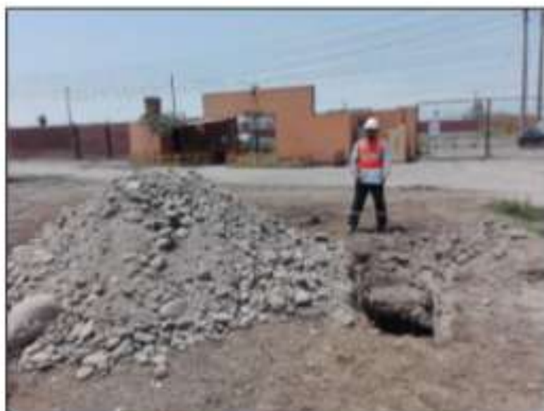
FOTO 3 Y 4 EN LAS VISTAS MOSTRADAS SE OBSERVA LA UBICACION DE LA CALICATA P-1, CONFORMADO POR SUELO LIMOSO LIGERAMENTE ARCILLOSO CON GRAVAS AISLADAS, SEMICOMPACTO, SUBYACIENDO SUELO GRAVOSO POBREMENTE GRADUADA, CON BOLONERIA DE TAMAÑO MÁXIMO DE 22", EN ESTADO SEMICOMPACTO.
