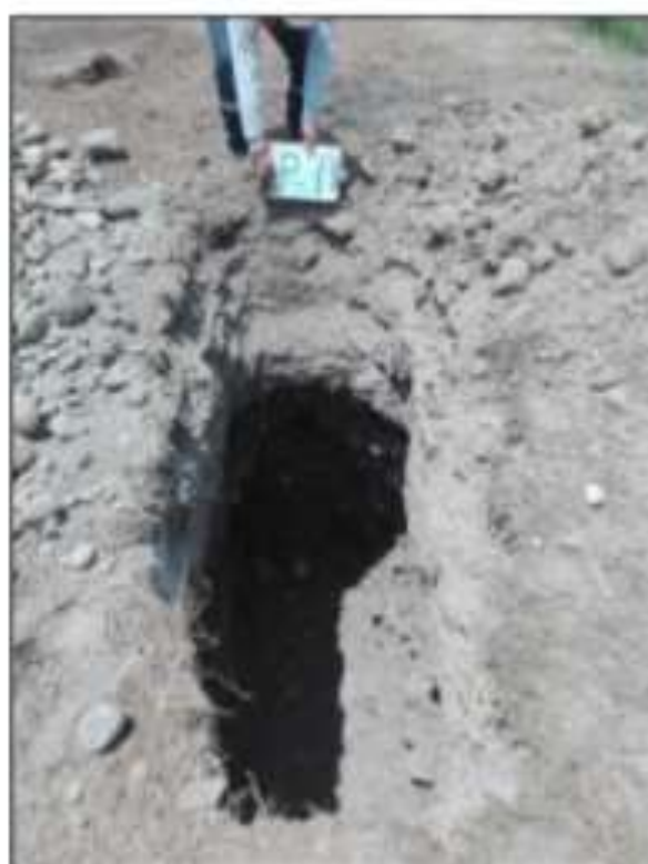
FOTO 3 Y 4 EN LAS VISTAS MOSTRADAS SE OBSERVA LA UBICACION DE LA CALICATA P-1, CONFORMADO POR SUELO LIMOSO LIGERAMENTE ARCILLOSO CON GRAVAS AISLADAS, SEMICOMPACTO, SUBYACIENDO SUELO GRAVOSO POBREMENTE GRADUADA, CON BOLONERIA DE TAMAÑO MÁXIMO DE 22", EN ESTADO SEMICOMPACTO.
