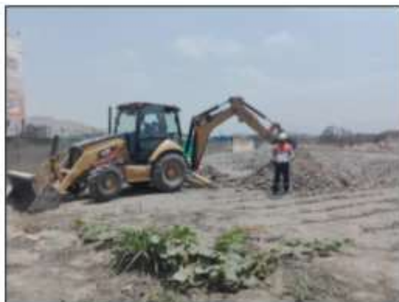
FOTO 5 Y 6 EN LAS VISTAS MOSTRADAS SE OBSERVA LA UBICACION DE LA CALICATA P-2, CONFORMADO POR SUELO LIMOSO LIGERAMENTE ARCILLOSO CON GRAVAS AISLADAS, SEMICOMPACTO, SUBYACIENDO SUELO GRAVOSO POBREMENTE GRADUADA, CON BOLONERIAS EN ESTADO SEMICOMPACTO.
