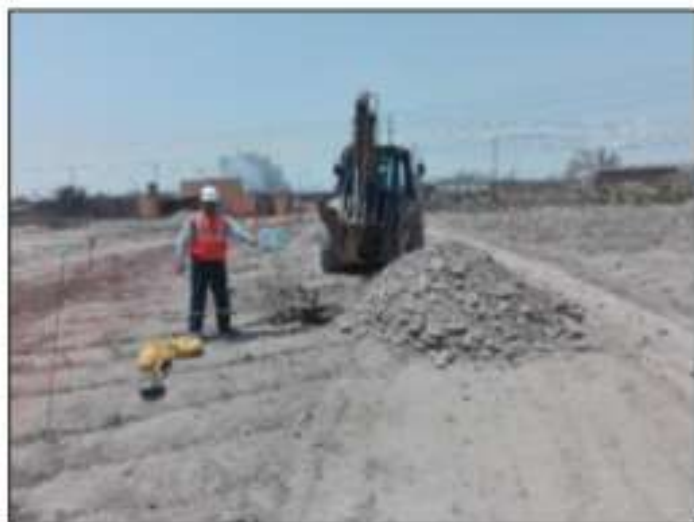
FOTO 9 Y 10 EN LAS VISTAS MOSTRADAS SE OBSERVA LA UBICACION DE LA CALICATA P-3, CONFORMADO POR SUELO LIMOSO LIGERAMENTE ARCILLOSO CON GRAVAS AISLADAS, SEMICOMPACTO, SUBYACIENDO SUELO GRAVOSO POBREMENTE GRADUADA, CON BOLONERIAS EN ESTADO SEMICOMPACTO.
