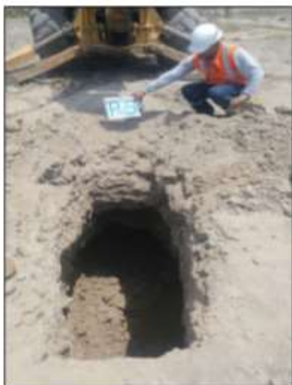
FOTO 19 Y 20 EN LAS VISTAS MOSTRADAS SE OBSERVA LA UBICACION DE LA CALICATA P-5, CONFORMADO POR SUELO LIMOSO LIGERAMENTE ARCILLOSO CON GRAVAS AISLADAS, SEMICOMPACTO, SUBYACIENDO SUELO GRAVOSO POBREMENTE GRADUADA, CON BOLONERIA DE TAMAÑO MÁXIMO DE 1/8", EN ESTADO SEMICOMPACTO.
