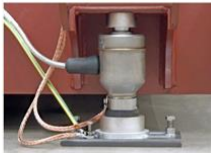
COMPETENCIA: SOPORTE INFERIOR A PERFIL CONCAVO, DONDE INGRESA LA SUCIEDAD
