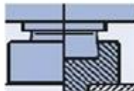
COMPETENCIA: SOPORTE INFERIOR A PERFIL CONCAVO, DONDE INGRESA LA SUCIEDAD
