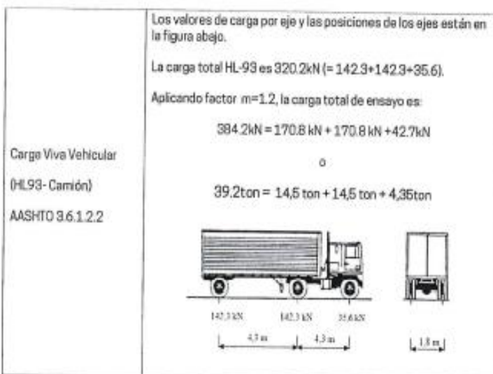
FIGURA 1: DEFINICIÓN DE LA CARGA DE ENSAYO.
