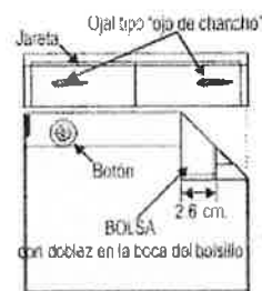
BOLSILLO DELANTERO detalle de la doblaz en la boca del bolsillo
