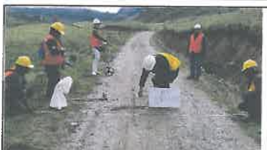
Foto N° 541: Prueba de la anchura de la superficie de rodadura en el Km 27+000.
