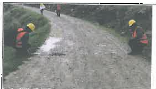
Foto N° 185: Prueba de la anchura de la superficie de rodadura en el Km 09+200.
