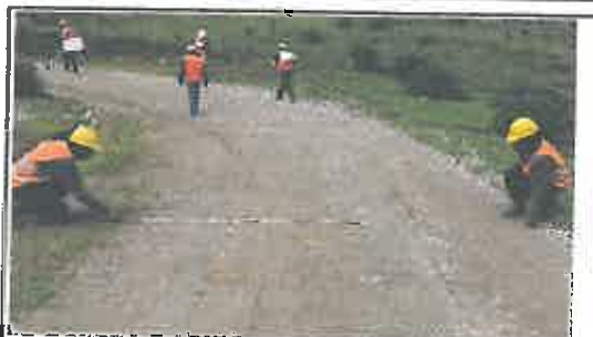
Foto N° 27: Prueba de la anchura de la superficie de rodadura en el Km 01+300.
