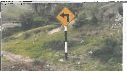
Foto N° 43: Señal preventiva de 0.8 x 0.8 m en buen estado, alerta de una curva pronunciada a la izquierda, ubicada en la progresiva 04+180.
