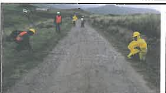
Foto N° 515: Prueba de la anchura de la superficie de rodadura en el Km 25+700.
