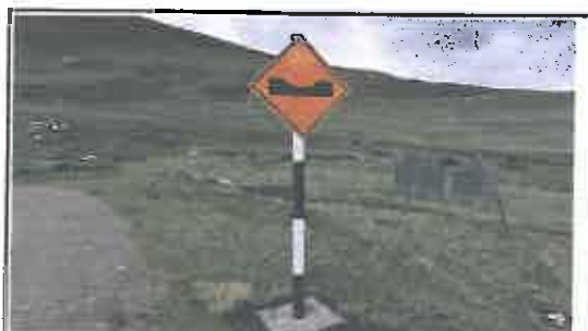
Foto N° 181: Señal preventiva de 0.8 x 0.8 m en buen estado, alerta la proximidad de un badén, ubicada en la progresiva 29+613.
