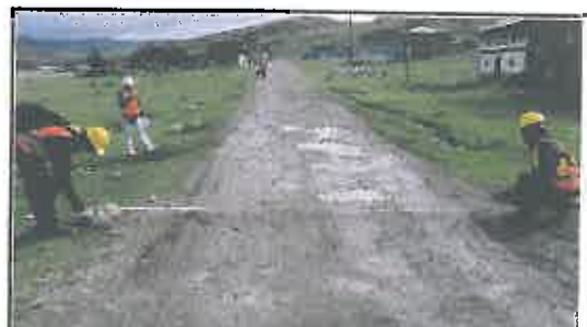
Foto N° 258: Prueba de la anchura de la superficie de rodadura en el Km 12+850.
