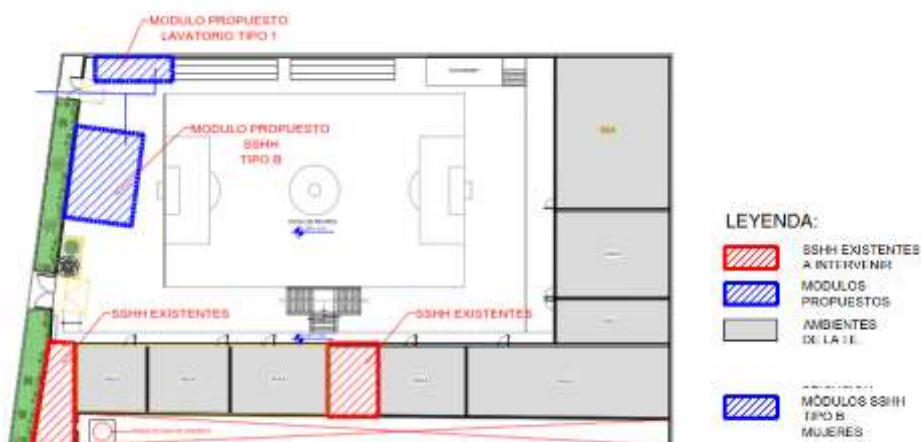
Gráfico N°01. Esquema de ubicación de los SSHH existentes y módulos proyectados
