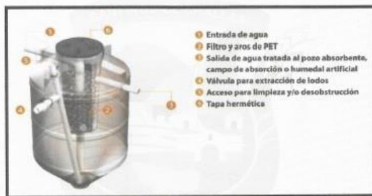
Ilustración N° 13: Esquema de biodigestor autolimpiable Fuente: Catálogo multiproducto – Rotoplas
