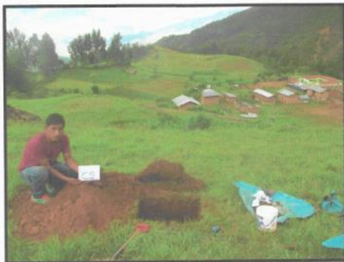
Ilustración N° 9: Calicata de inspección en terreno proyectado para construcción de reservorio de agua
