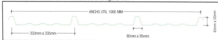
La cobertura metálica Aluzinc podrán ser del formato tr4, rt4, pv4 u otros similares que cumplan con las dimensiones del formato y las características técnicas.
