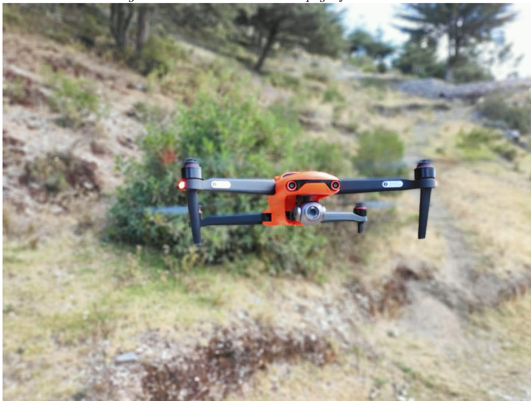
Figura 2.2: Levantamiento Topográfico con RPA
