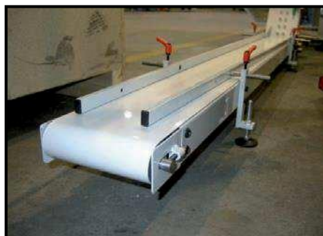
Figura 4: Foto referencial faja transportadora de cartuchos con guías regulables.
