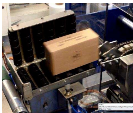
Figura 12: Foto referencial volteador transportador de cajas cartuchos.
