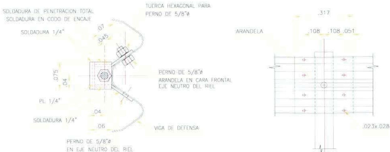
Detalle de conexiones de guardavías y accesorios
