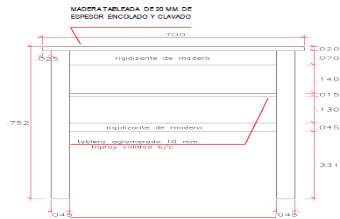
ELEVACIÓN LATERAL - MESA ESC: 1/10
