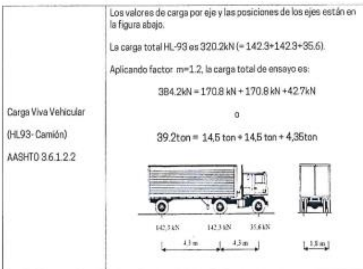
FIGURA 1: DEFINICIÓN DE LA CARGA DE ENSAYO.
