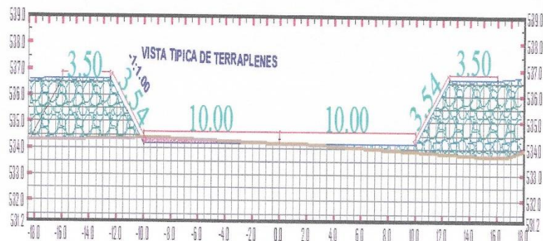
Sección Típica conformación de Terraplén
