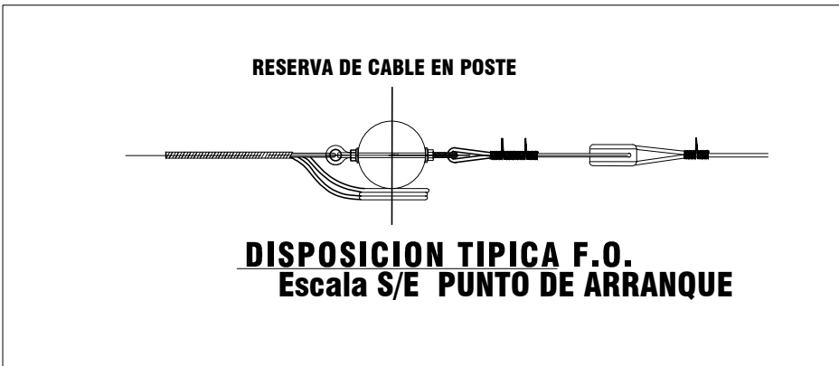
DETALLE 02 CONJUNTO DE EMPALME OPTICO EN POSTE Escala S/E
