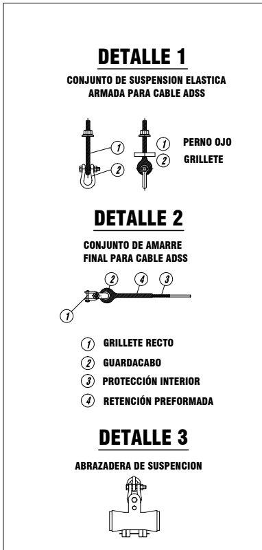
DETALLE TIPICA F.O. Escala S/E RETENCION DE CABLE F.O.
