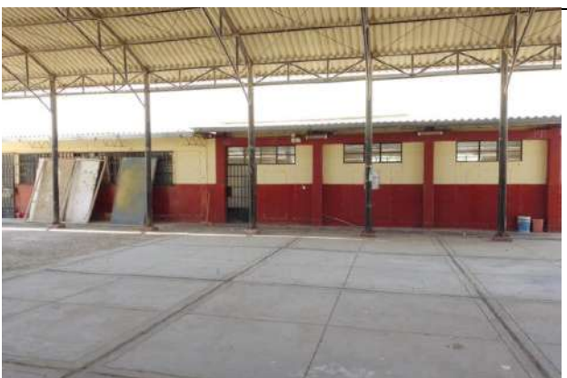
Vista de edificio 5, 6, (aulas - almacen), cobertura liviana de calamina, muros de albañileria confinada
