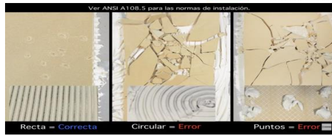
Figura 6. Esquema de esparcimiento del pegamento sobre el sustrato.
