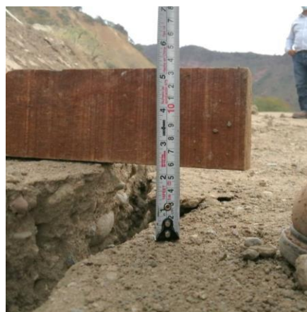
Fotografía N° 16.- Grieta y asentamiento (04.08.2021)
