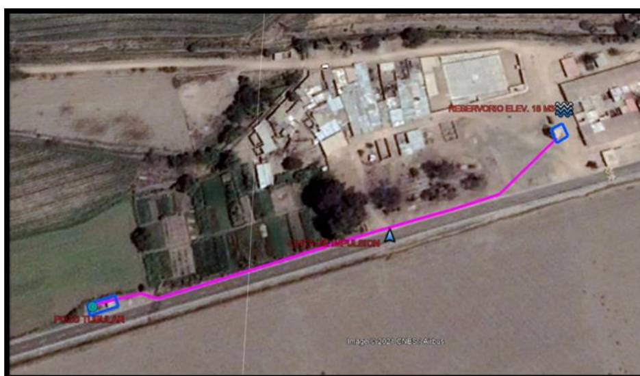
FOTOGRAFÍA N° 06: En esta imagen se puede apreciar el trayecto de la L.C, se encuentra enterrada.
