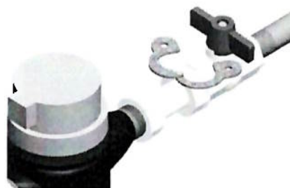
2) Abrir e instalar el dispositivo grillete.
