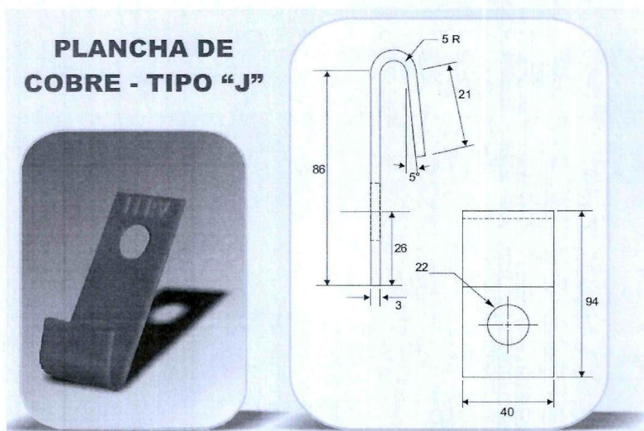
IMAGEN N° 21: Detalles de fabricación para Plancha de Cobre Tipo "J".
