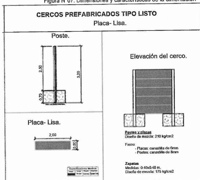
Figura N°08: Dimensiones y características del cerco prefabricado
