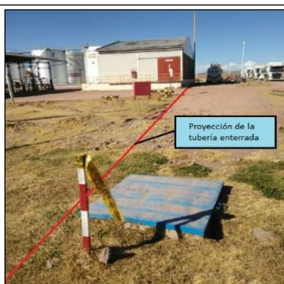
Figura N° 02: Proyección de la tubería enterrada.
