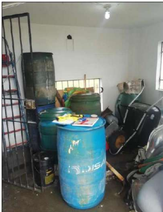
Fotografía N° 28: Inadecuado almacenamiento de combustible
