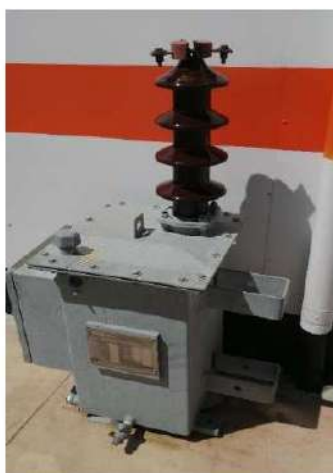
Fotografía N° 18: Transformix dañado.
