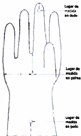
FIGURA N° 2: Puntos de medición para espesor
