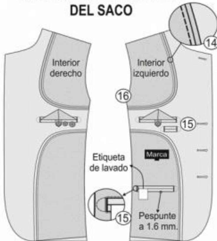
14 **VUELTA** : Unión de forro con vuelta, lleva sesgo ( contraste ) / Pespunte ( contraste ), Sesgo de forro armado de cordoncillo de refuerzo ( chutas ) y pespunte tipo hlván ( cadeneta al reverso ).
