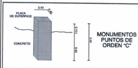
Figura: Diseño del monumento de concreto establecido para el punto de orden "C".
