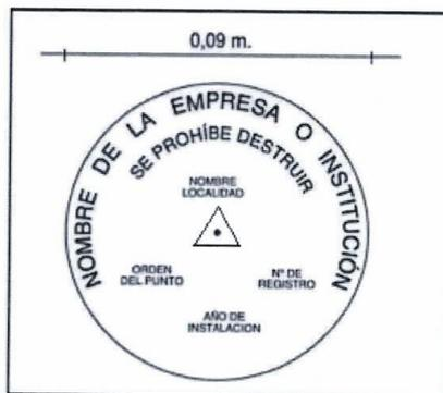
Figura: Diseño de la inscripción en la placa de bronce para señalar el punto control de orden "C".
