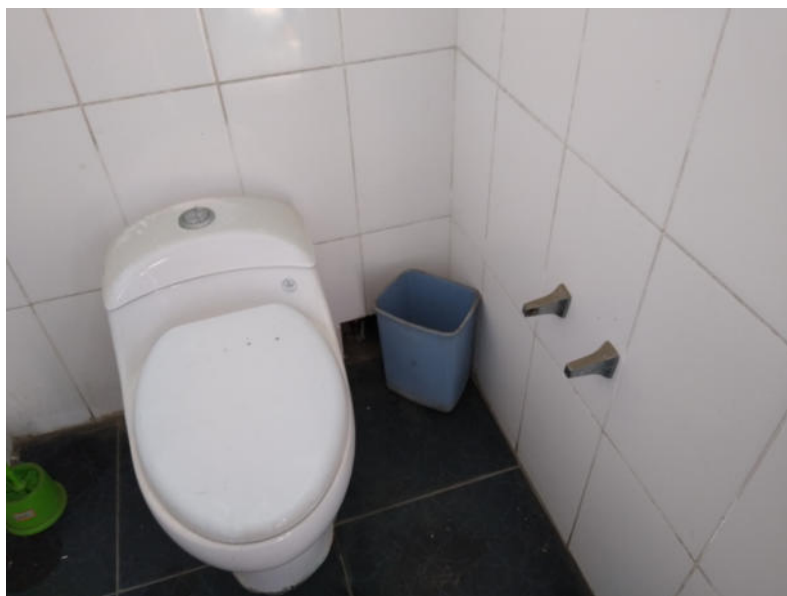
Fotografía 20: Módulo 03 (baño varones docentes de primaria), se evidencia el buen estado del inodoro, portarrollos de papel en mal estado y fragua del enchape cerámico en regular estado.
