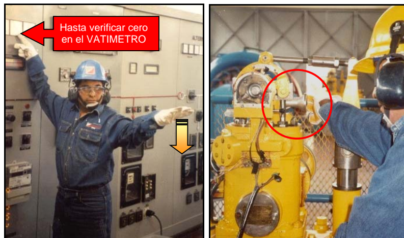
SENTIDO DE GIRO DE LA PERILLA DEL VARIADOR DE VELOCIDAD PARA DISMINUIR LA CARGA
