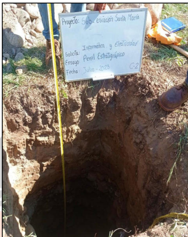
Gráfica 11. Medición de profundidad de la calicata C-02
