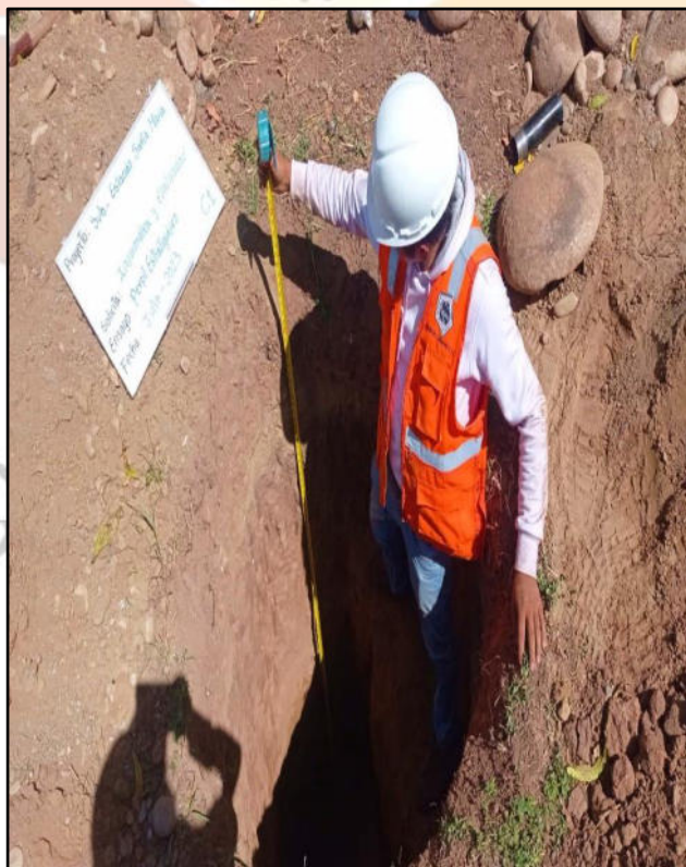
Gráfica 10. Medición de profundidad de la calicata C-01
