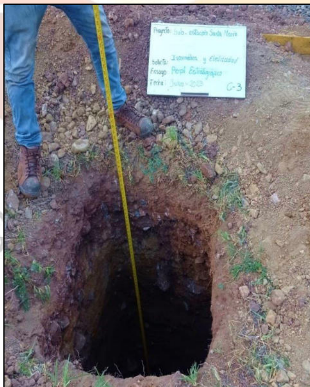
Gráfica 12. Medición de profundidad de la calicata C-03.
