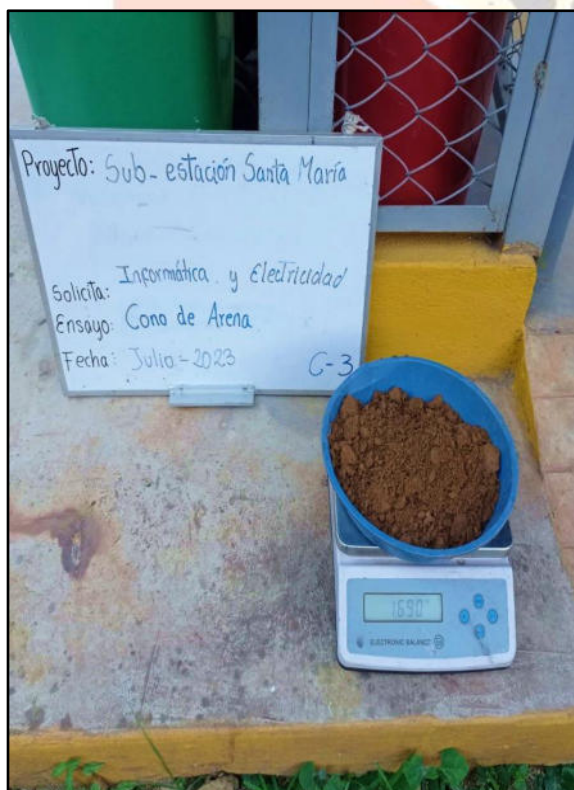
3.- MUESTRA DEL ENSAYO DE CONO DE ARENA
