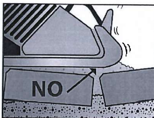
Figura 17. Sellado de juntas (evitar acumulaciones de arena)
