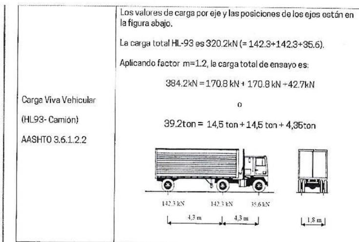
FIGURA 1: DEFINICIÓN DE LA CARGA DE ENSAYO.
