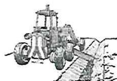
La siguiente pasada limpia el talud exterior y saca el material en el borde superior de la cuneta.
