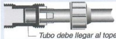
: Inserte la tubería en el cuerpo del accesorio (junto con la garra y el anillo de goma). Asegúrese de que la tubería llegue al tope (verifique su marca).
