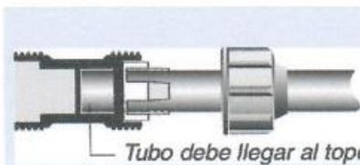
: Inserte la tubería en el cuerpo del accesorio (junto con la garra y el anillo de goma). Asegúrese de que la tubería llegue al tope (verifique su marca). Por el momento la tuerca debe seguir libre.
