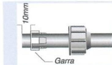
: Inserte la tuerca y la garra en la tubería. La tuerca por el momento debe quedar libre.
