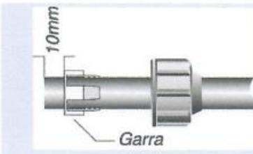
: Inserte la tuerca y la garra en la tubería. La tuerca por el momento debe quedar libre.
